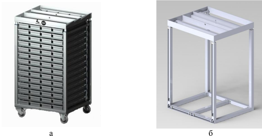
Рисунок 1 – Фото стеллажа для термической обработки мясных изделий (а) и компьютерная модель (б) механизма подъёма стеллажа для термической обработки мясных изделий
