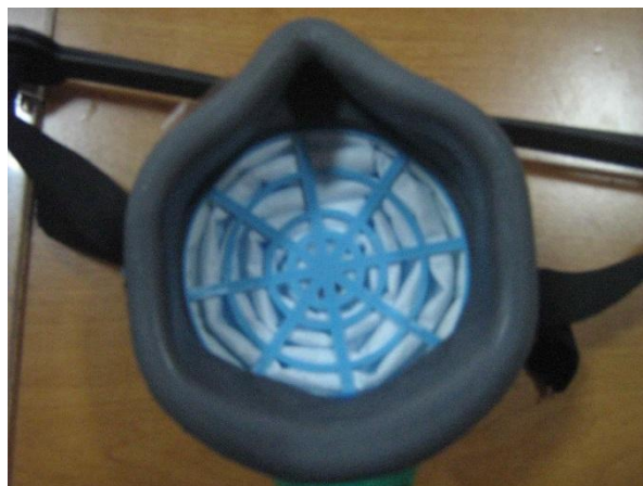
Рисунок 3 – Зворотня сторона респіратору Шахтар
