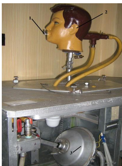
Рисунок 1 – Стенд для визначення опору півмасок: 1 – пробовідбірник з підмаскового простору ЗІЗОД; 2 – шеффілдський муляж голови; 3 – пневмоциліндр
