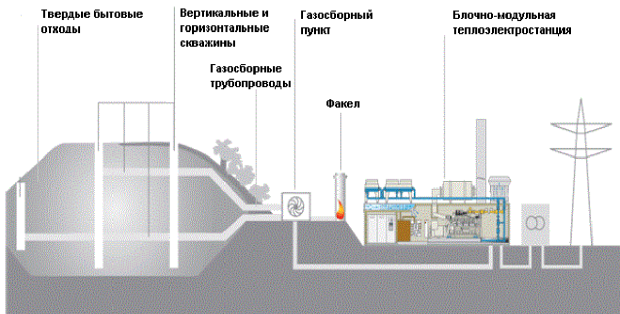
Рисунок 1 - Схема дегазации полигона твердых бытовых отходов
