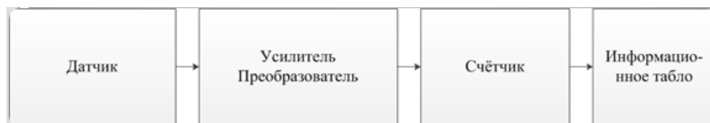
Рисунок 1 – структурная схема измерителя двигательной активности
