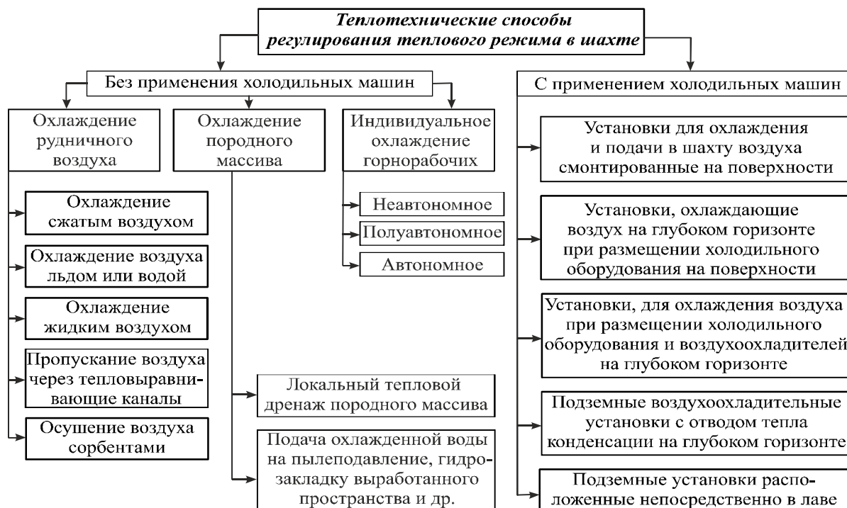
Рисунок 1 – Теплотехнические способы регулирования теплового режима в шахтах
