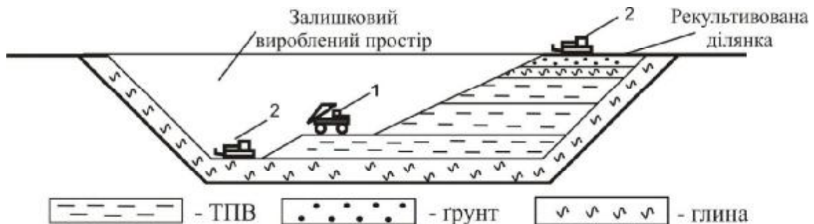
Рисунок 1 – Технологічна схема рекультивації виробленого простору кар'єру: 1 – автосамоскид; 2 – бульдозер
