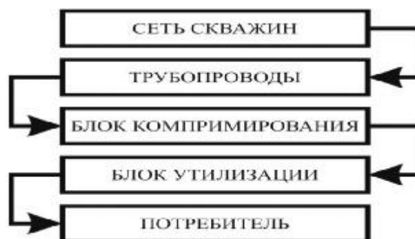
Рисунок 1- Блок схема установки для добычи и утилизации биогаза
