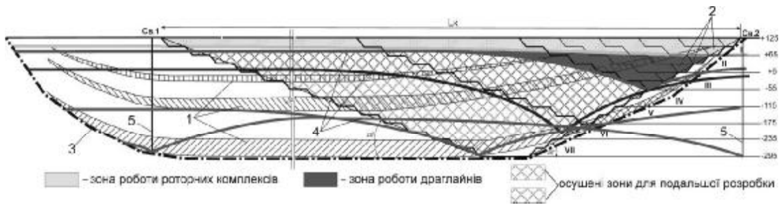
Рисунок – Схема послідовності розкриття продуктивних покладів Ново-Дмитрівського буровугільного родовища: 1 – горизонти бурого вугілля; 2 – розрізні траншеї розкриття; 3 – контури кар'єрного поля; 4 – лінії депресійної воронки; 5 – водознижуючі свердловини
