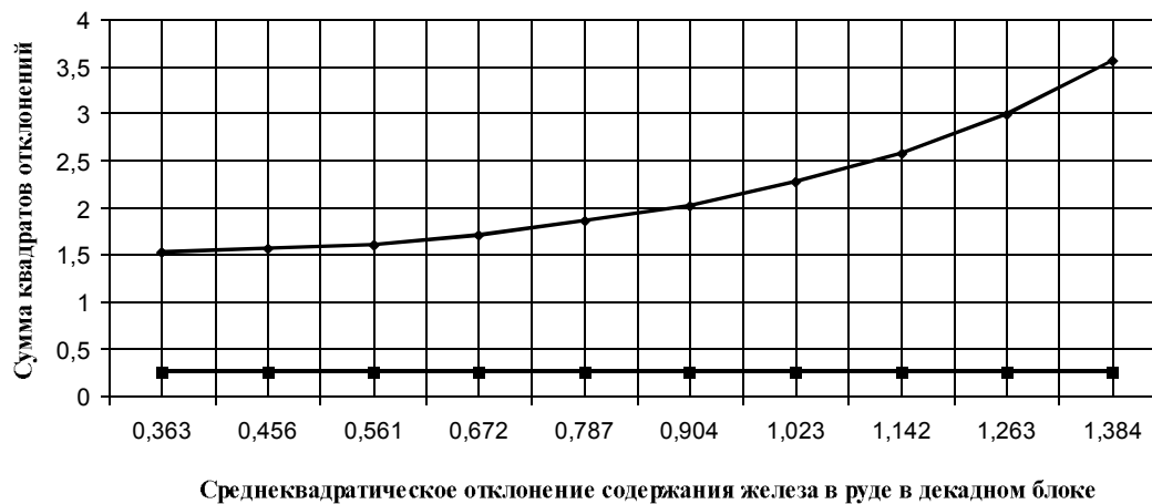
Рисунок – Зависимость значения критерия оптимальности от колеблемости среднего содержания железа в декадных блоках.
