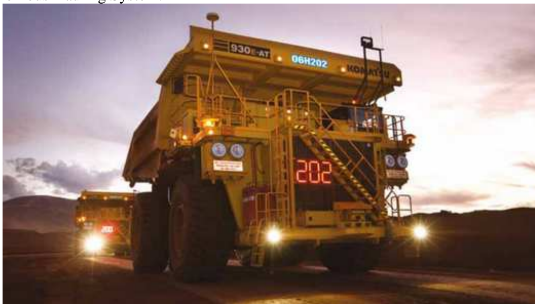
Рисунок 1 – Роботизированный карьерный самосвал Komatsu
