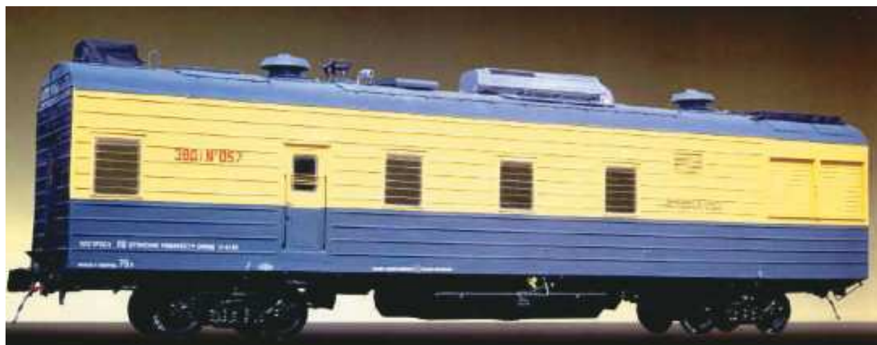
Рисунок 4- Современный вариант этой электростанции - ЭВД-1 мощностью 1,1 МВт.
