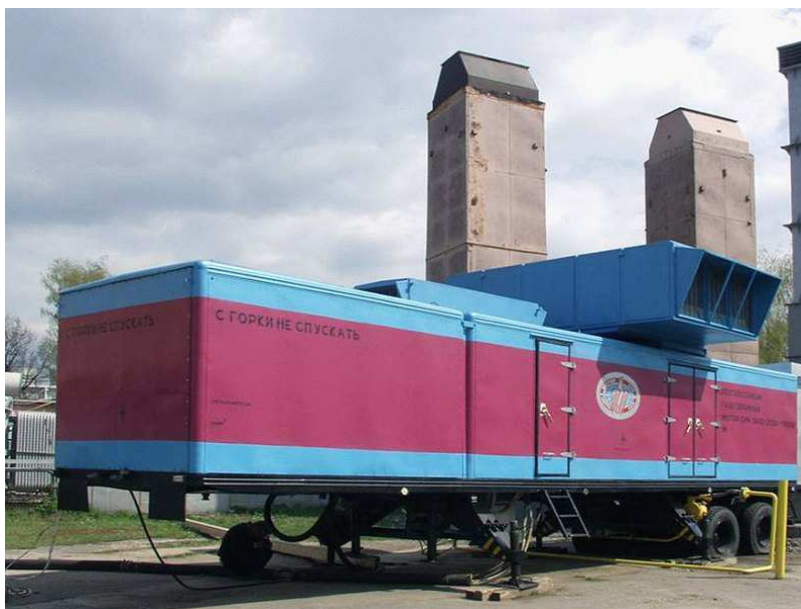
Рис. Передвижная автоматизированная газотурбинная электростанция ЭГ-2500Г-Т10500
