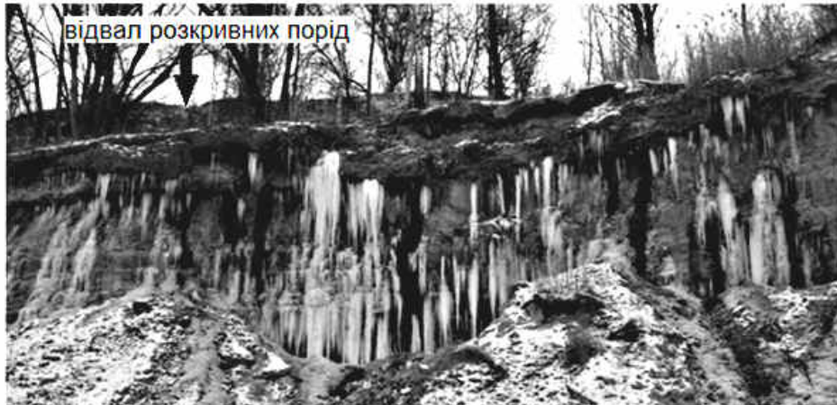
Рисунок 1 – Вихід води в зоні зчленування осадового чохла і фундаменту, Піщанський кар'єр, м. Кременчук
