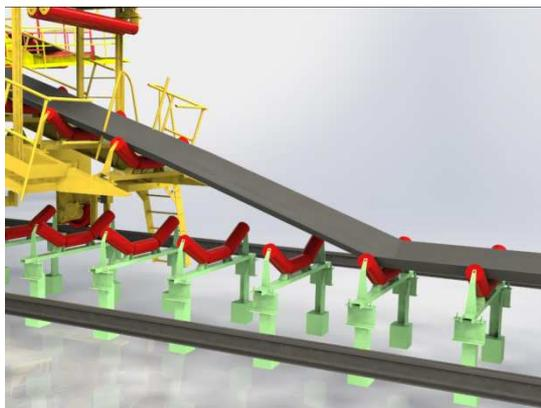
Рисунок 1 — Переходной участок конвейера
