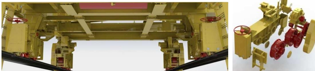
Рисунок 1.– Компьютерная модель ходовой тележки
