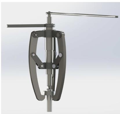
Рисунок 1 – Съемник подшипников
