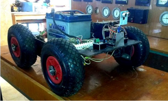
Рисунок 1 – Експериментальна колісна база системи геотехнічного моніторингу екземптованих територій
