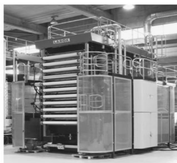
Рисунок 2 – Принципиальная схема и общий вид фильтр-пресса ФПАКМ
