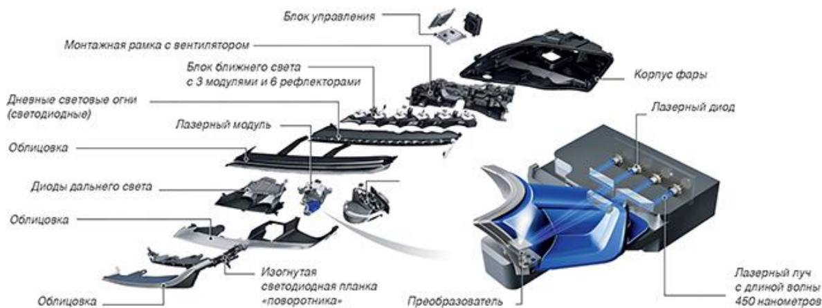
Рис.2 Конструкция лазерной фары Audi
