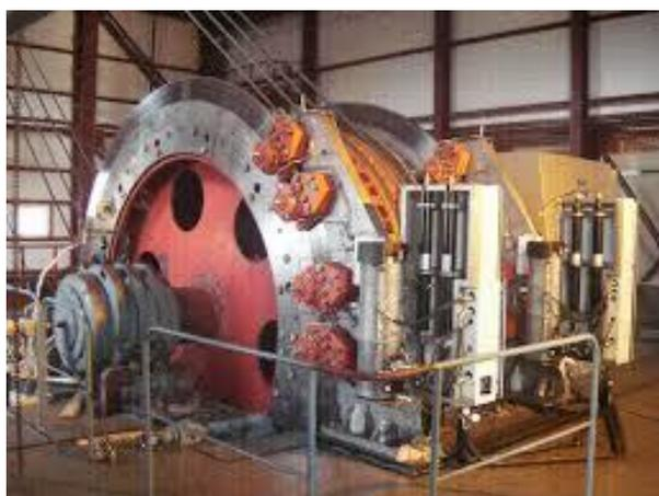
Рисунок 1 – Многоканатная подъемная машина с наземным расположением
