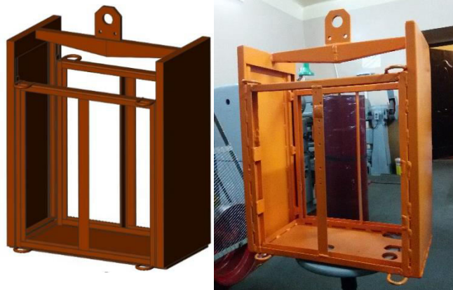
Рисунок 2 – Скіп а) зображення тривимірної моделі; б) готовий вузол скіпу
