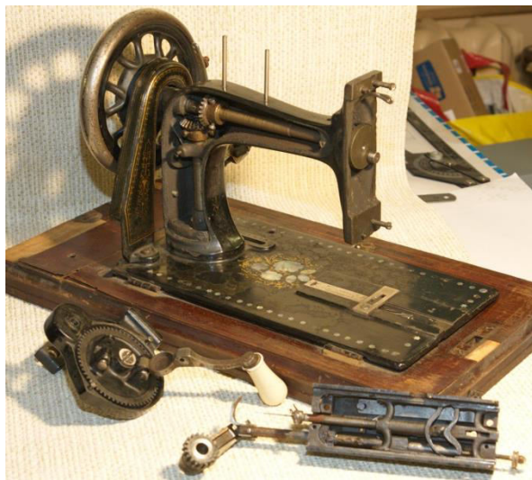
Рисунок 2 – Механізм швейної машинки Nähmaschinen&Fahrrad Fabrik Hengstenberg: а – вихідна конструкція; б – комп'ютерна модель з її масовими характеристиками
