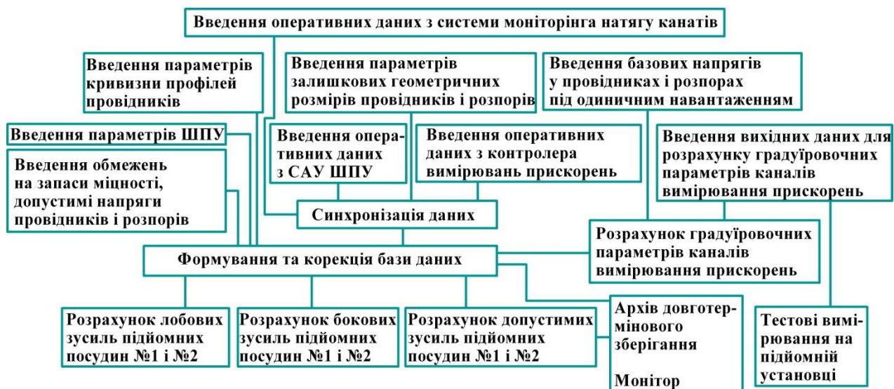
Рис. 1 - Функціонально-структурна схема програмного забезпечення системи безперервного контролю плавності посудин
