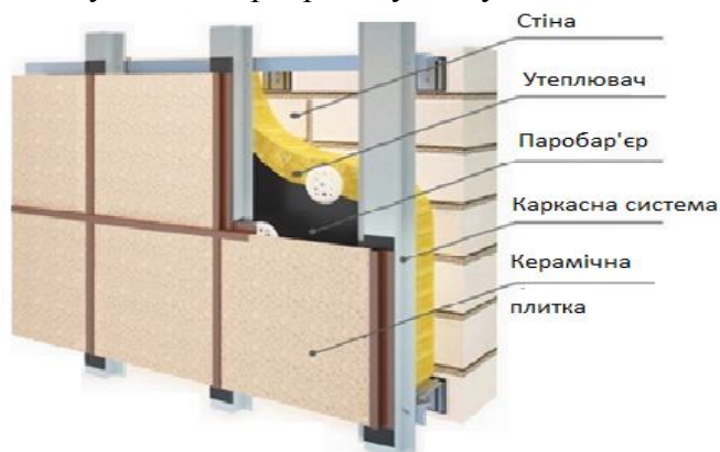
Рис. 1. Схема конструкції для внутрішнього утеплення
