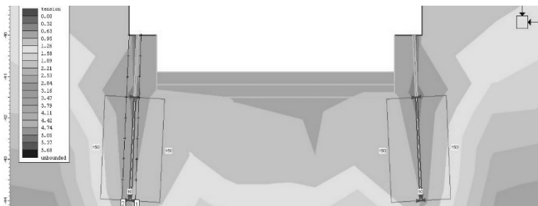
Рисунок 2. Распределение strength-фактора в забое ствола после взрывания шпуров при h_y = 0,9 м
