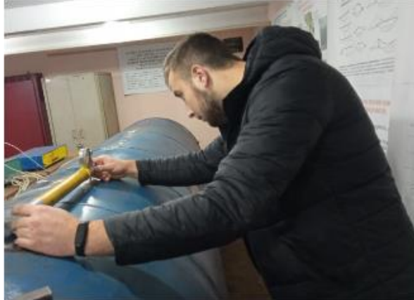
Рисунок 1 – Вимірювання деформацій механічним тензометром
