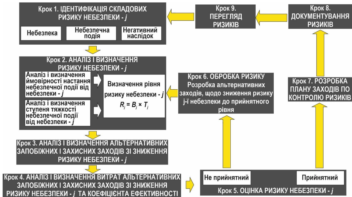
Рисунок 1 Процес керування логістичними ризиками з визначення запобіжних заходів з урахуванням значення коефіцієнту ефективності зі зниження ризику за умови мінімізації фінансових витрат
