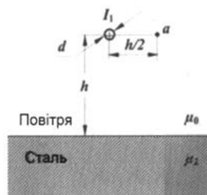
Рисунок 1- Схема електричного провoda, розміщеного біля сталевій маси
