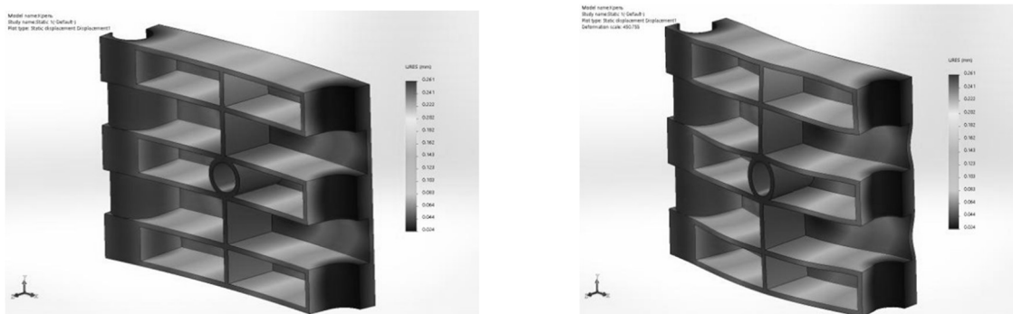
Рис. 5. Розподіл деформації в елементі
