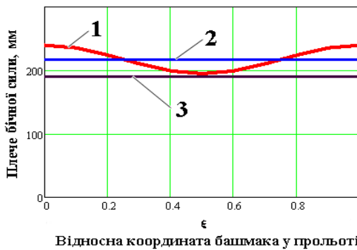
Рис. 4 – Графік залежності плеча бічної сили від положення башмака посудини у прольоті між ярусами армування:
