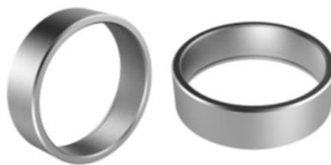
Рисунок 1 – Поковка після токарної обробки.
