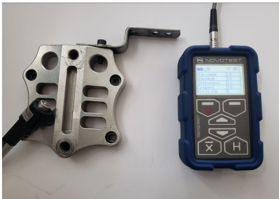
Рис.5 Вимірювання твердості оновленої деталі «Упор двигуна»
