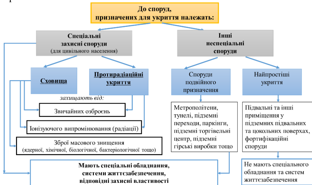
Рисунок 1 – Схема загальної типізації захисних споруд
