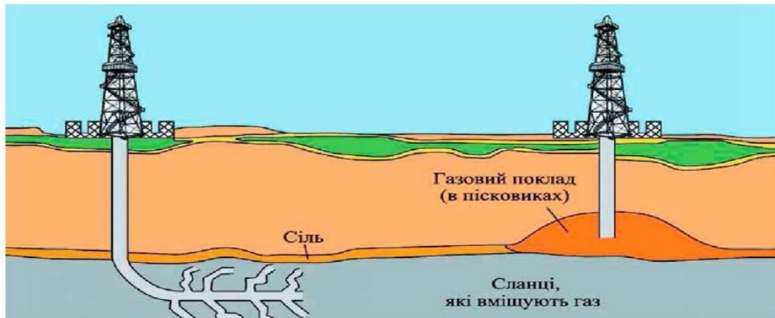
Рисунок 2 – Схема видобутку газу горизонтальними і вертикальними свердловинами
