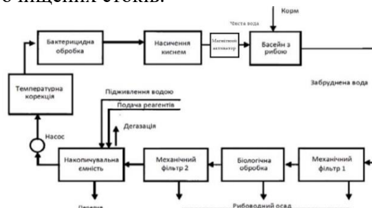
Рисунок 1 - Принципова схема Рециркуляційної аквакультурної системи
