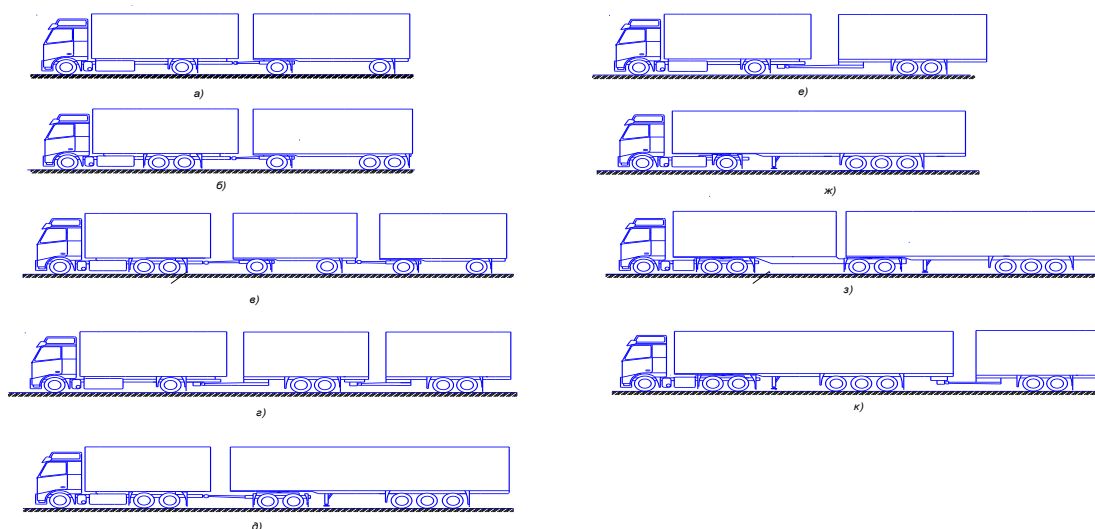
Рисунок 1 — Компонувальні схеми автопоїздів
