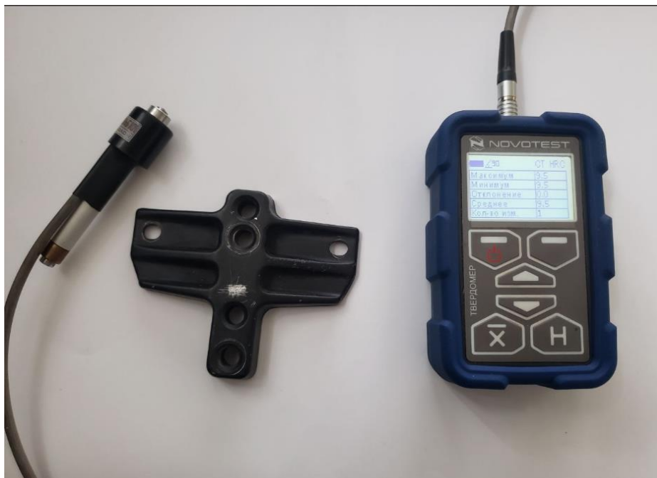
Рис.3 Вимірювання твердості деталі «Упор двигуна»
