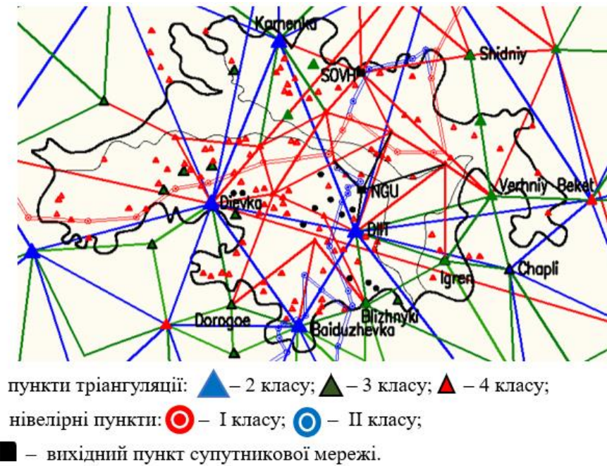
Рисунок 1 – Схема геодезичної мережі м. Дніпропетровськ станом на 2012 р [2].
